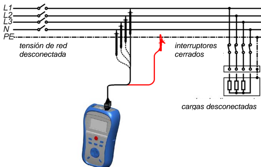
Figura 5.2: Conexión del cable de prueba universal
